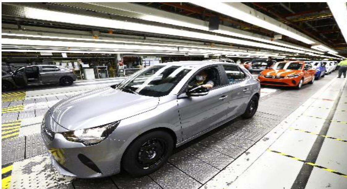
COCHES INSPECCIONADOS EN BANDAS
